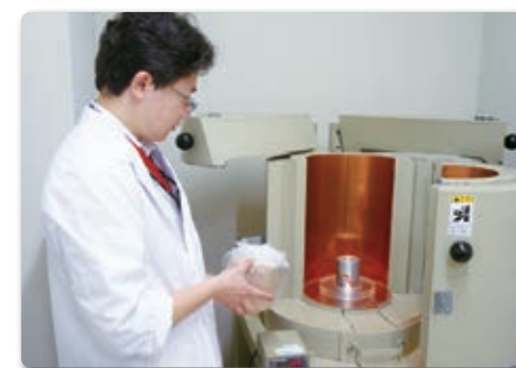
▲細かくした検体を詰めた容器を検出器にセットして測定します。
