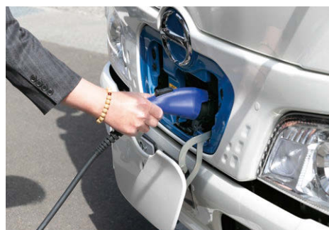
EVトラックフロント部分の充電口
