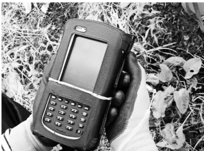
測定器で測った数値は、受信機に表示される。表示された測定結果を、地図に落とし込んでいく。
