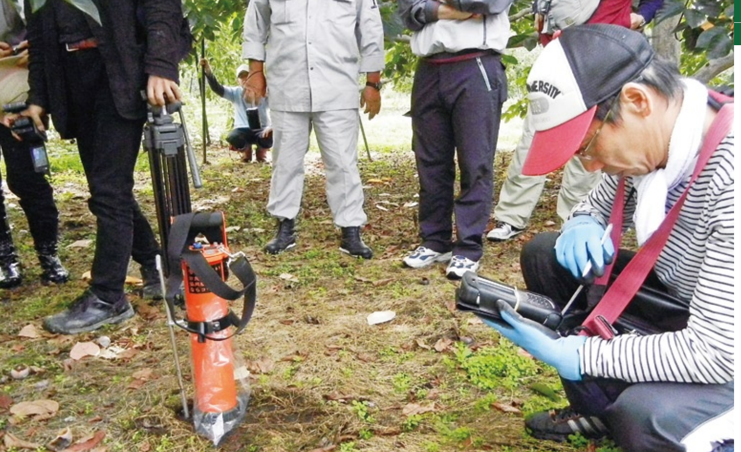
ベラルーシ製のGPSと連動した検査器を使う。中央のオレンジ色の機器が、放射線測定器(土壌スクリーニング機)。6台のうち2台は、ならこープが寄贈。
